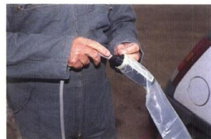
Figure 7 : Introduction d'une sonde linéaire et de son câble dans une poche de protection en polyéthylène
